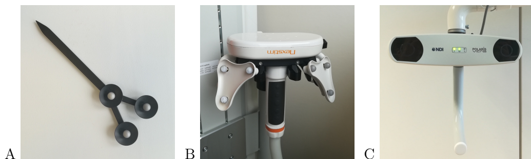
Abb. 2.2 Elemente des Nexstim-Untersuchungssystems: Infrarot-Zeigestift (A), Magnetspule (B), stereotaktische Infrarotkamera (C). Quelle: eigene Abbildung.
