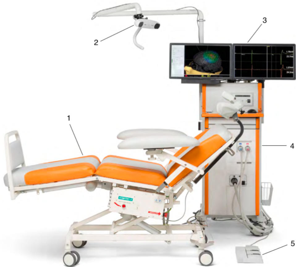
Abb. 2.1 Gesamtaufbau des Nexstim-Untersuchungssystems in der Übersicht. Hier dargestellt sind der Untersuchungsstuhl für die Patienten (1), die stereotaktische Infrarotkamera (2), der Bildschirm zur Neuronavigation durch den Untersucher (3) und das TMS-Gerät selbst (4) mit Fußpedal (5). Quelle: https://nexstim.com/fileadmin/Downloads/Brochures/NX112954-A_Nexstim_NBS_System_5_Specifications_US.pdf
