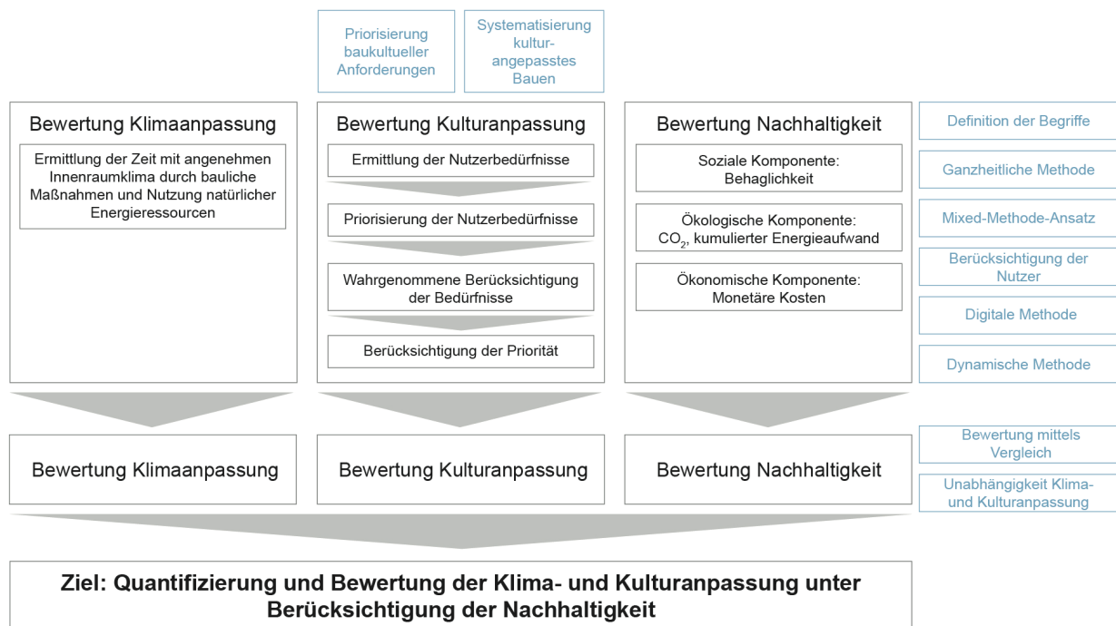
Abbildung 39 Erweiterte Grundstruktur der neu zu entwickelnden Methode zur Quantifizierung und Bewertung des klima- und kulturangepassten Bauen unter Berücksichtigung der Nachhaltigkeit
