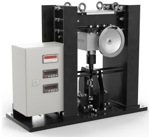
Bild 6.10: Vorrichtung zur Kalibrierung der Dehnmessstreifen am Planetenbolzen
