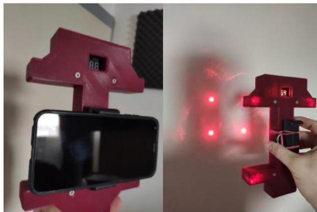
Abbildung 1: Referenzgerät zur Erzeugung eines optischen Maßstabs
