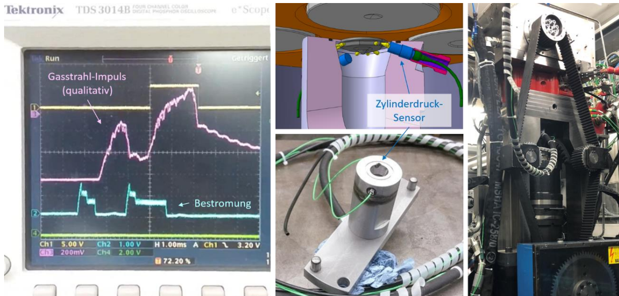
Abbildung 3-14 Aufbau zur qualitativen Beurteilung des Injektorverhaltens bei den Testeinspritzungen
