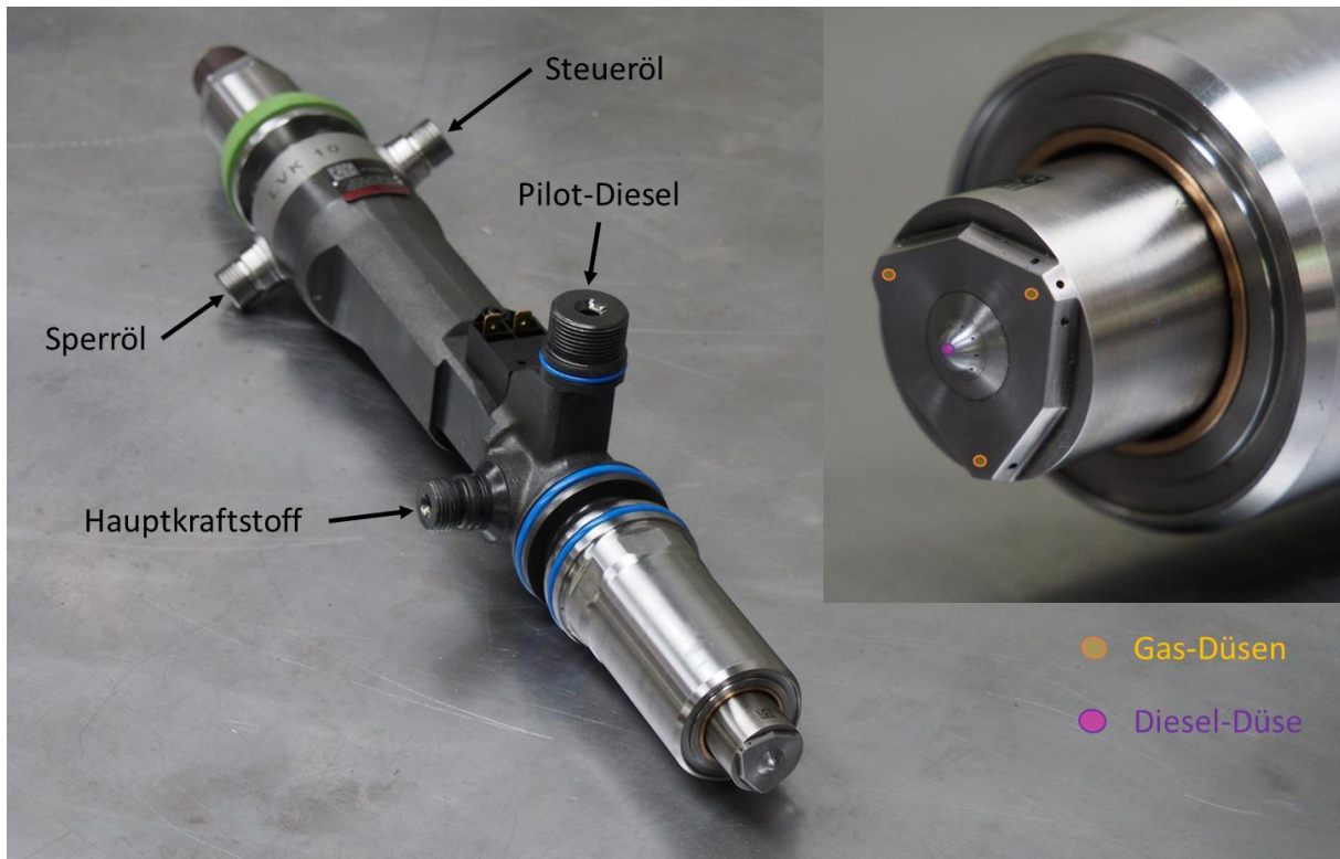
Abbildung 3-11 HPDF-Experimentalinjektor von Woodward L'Orange
