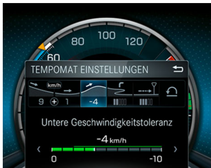
Abbildung A.4: Darstellung der Hysterese im HMI-Konzept des ECO-Tempomat von Mercedes Benz Trucks – Predictive Powertrain Control im Actros [231]
