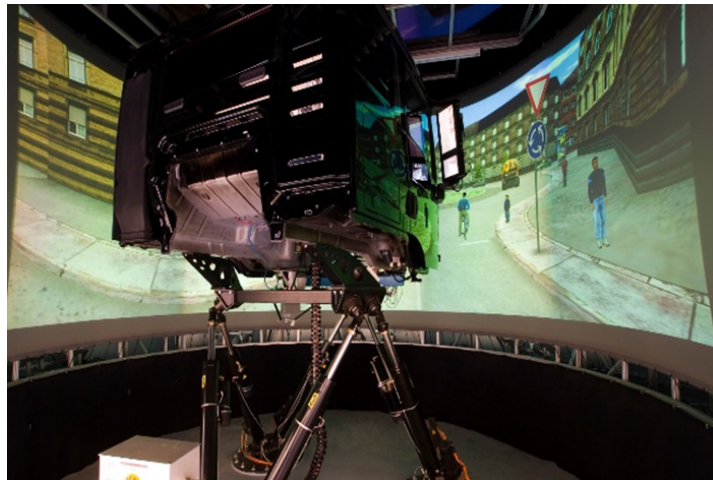
Abbildung 3.3: Dynamischer Lkw-Fahrsimulator des Lehrstuhls für Fahrzeugtechnik der Technischen Universität München
