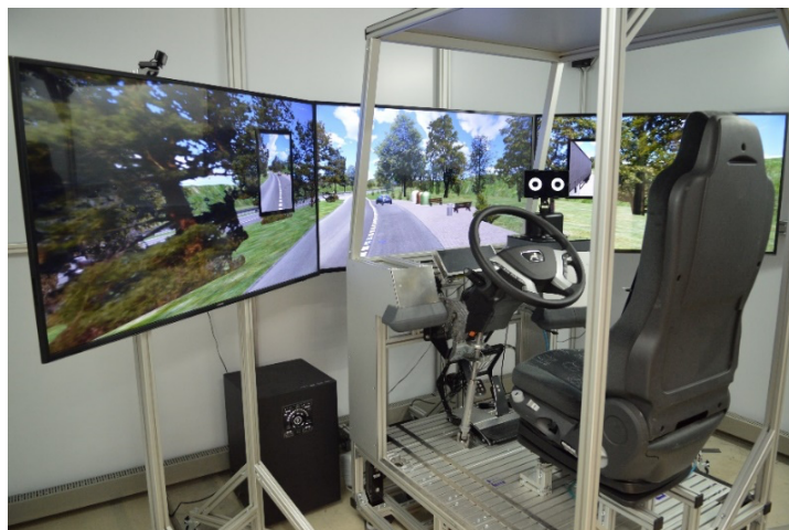
Abbildung 3.4: Dynamische Sitzkiste des Lehrstuhls für Fahrzeugtechnik der Technischen Universität München
