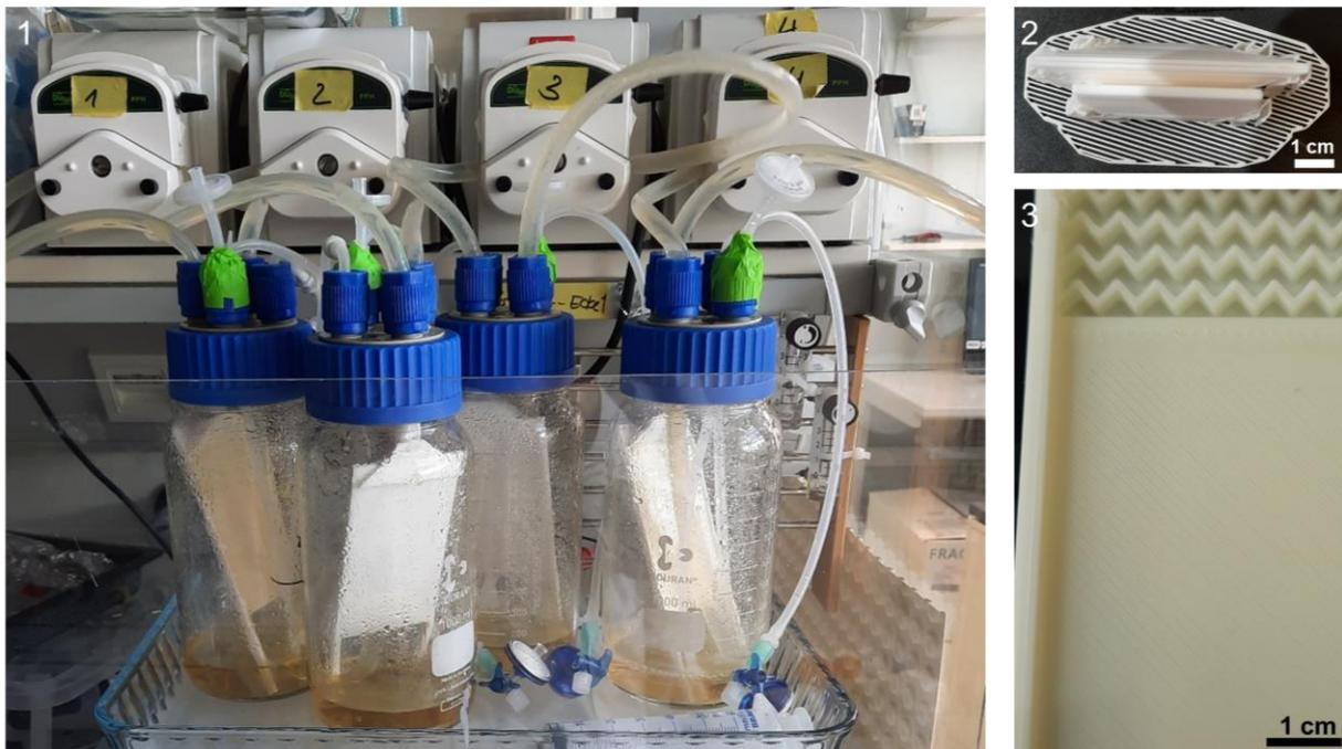
**Abbildung 16:** (1) Versuchsaufbau mit allen Komponenten; (2) Düse aus PLA kurz nach der Entnahme aus dem 3D-Drucker; (3) Bewuchsfläche mit sichtbaren Streifen auf der Oberfläche durch das Verschmelzen des PLA-Filaments.
