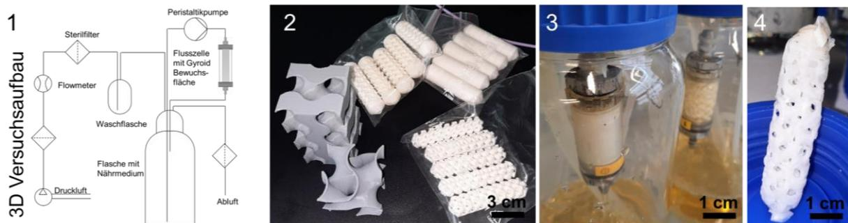
**Abbildung 46:** Flussdiagramm für den 3D-Versuchsaufbau (links); (1) 3D-gedruckte Gyroidkörper; (2) Flusszelle in der Flasche mit Einbau; (3) trockener Gyroid-Körper aus BC.
