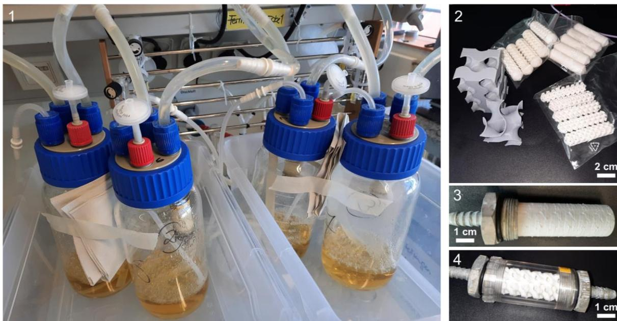
**Abbildung 17:** (1) Versuchsaufbau mit den Weithalsflaschen und den Flusszellen; (2) FDM-gedruckte Gyroid-Einbauten für die Flusszellen; (3) Gyroid in Hülle in einer Flusszellentülle; (4) Gyroid ohne Hülle in die Flusszelle mit Sichtfenster eingebaut.
