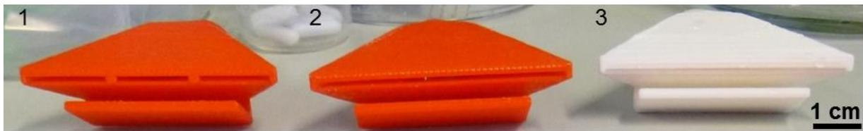
**Abbildung 38:** Verschiedene Düsengeometrien für die gleichmäßige Überströmung der Bewuchsflächen: (1) Breiter Düsenschlitz (0,75 mm) mit Stegen für ein besseres 3D-Druck-Ergebnis; (2) ähnliche Düse wie links (Schlitz 0,5 mm) nur ohne Stege; (3) Düse mit dünnerer Öffnung (0,3 mm).
