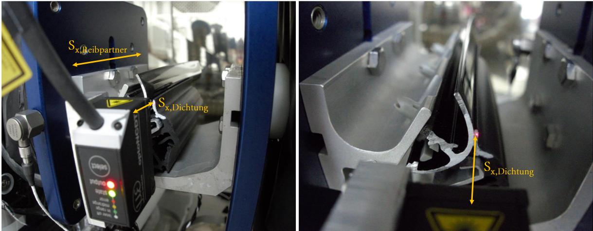
**Abbildung 6.8:** Versuchsaufbau zur Korrelation der Schwingungsmessung am Probenkontakt und an den Probenaufnahmen.
