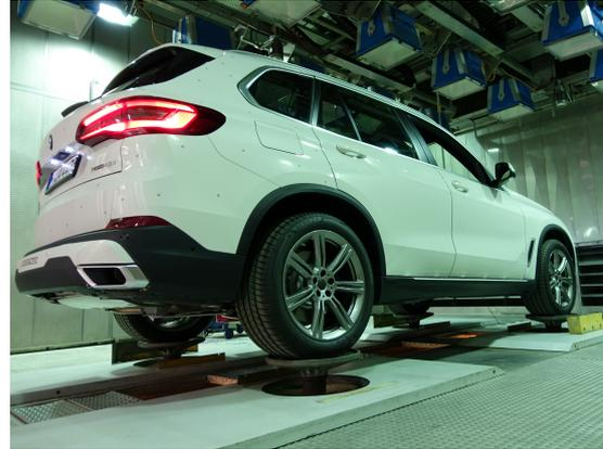
(b) Fahrzeug auf einer Hydropulsanlage
