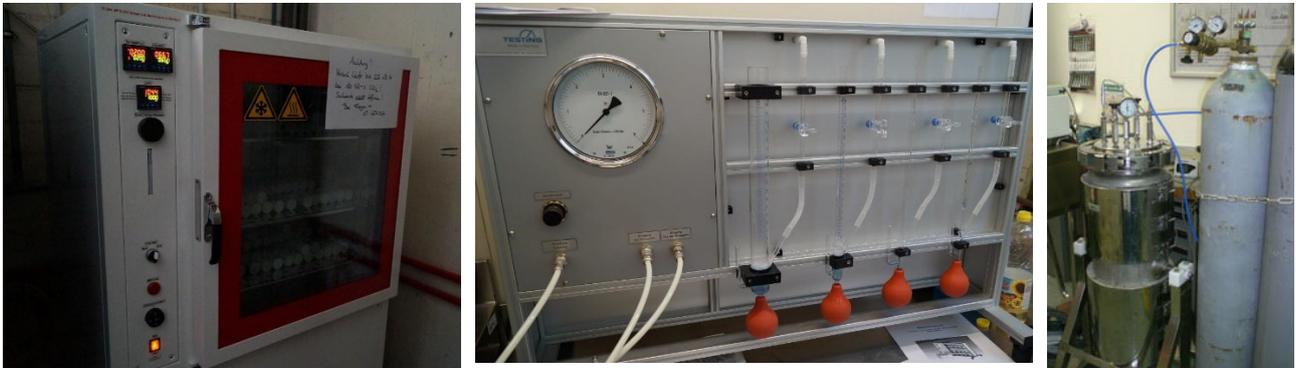
Abbildung 24: Übersicht der verschiedenen Methoden der CO<sub>2</sub>-Beaufschlagung (Links: Klimaschrank mit CO<sub>2</sub>-Steuerung, Mitte: Cembureau-Verfahren, rechts: Autoklav)
