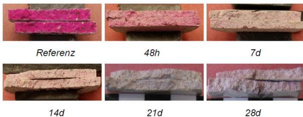
Abbildung D7: Farbumschlag M1\_0,07 bei 4 Vol.-% CO<sub>2</sub>
