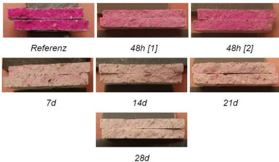
Abbildung D5: Farbumschlag M1\_0,07 bei 2 Vol.-% CO<sub>2</sub>
