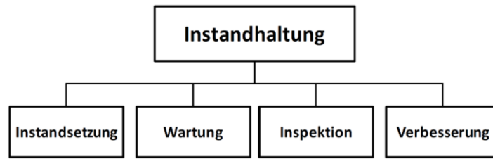
Abbildung 2-21: Maßnahmen der Instandhaltung nach DIN 31051. 270
