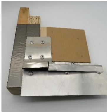
Abbildung 103 Detailanschluss Testelement an den Rahmen, unten außen
