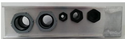
Abbildung 128 Aluminiumplatte mit Durchführung für 2x Luft-; 1x Strom-; 1x Datenleitung; 1x Reserveblindstopfen
