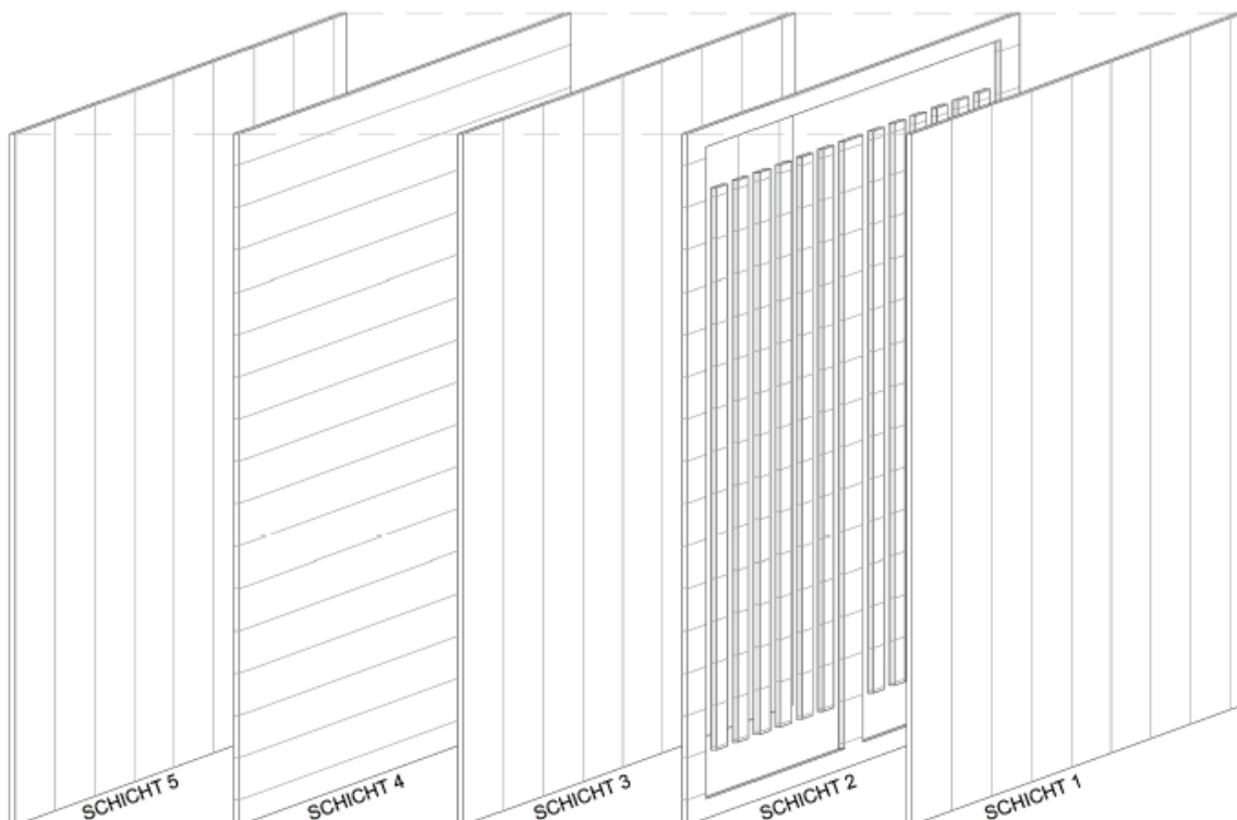
Abbildung 1 Deckplatte auf Massivholzelement mit gefrästen Kanälen, (Pape, 2020)
