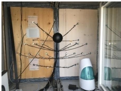
Abbildung 199 Messaufbau für die Experimente in Kubus Ost. Der Befeuchter wurde für diese Periode nicht benutzt.
