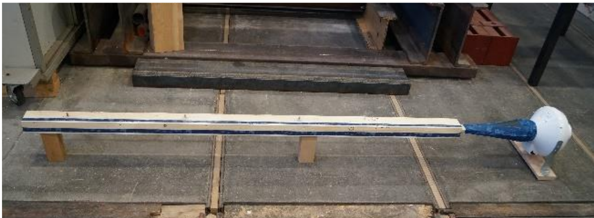
Abbildung 32 Versuchsaufbau zur Ermittlung der Sandkornrauigkeit k_s (Eckel, 2021)
