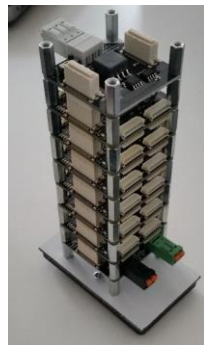
Abbildung 133 Brick-Stapel mit Montageplatte und Tragschienensockel
