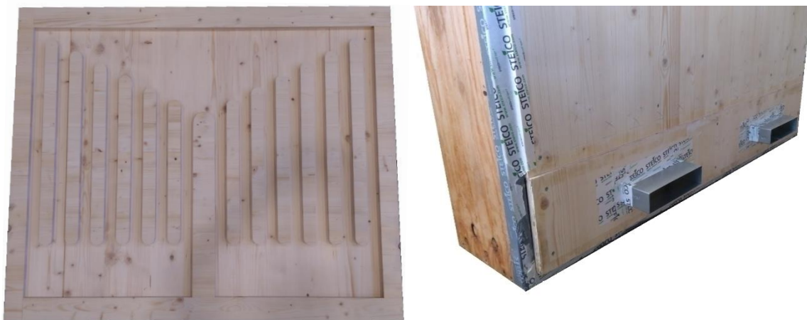
Abbildung 23 Luftkanalschicht des Prototyps C (links), Einström- und Ausströmöffnung (rechts) (eigene Darstellung)
