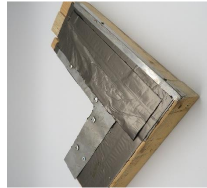
Abbildung 105 Detailanschluss Testelement an den Rahmen, oben außen
