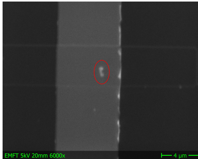
Abbildung 7.1.: Rasterelektronenmikroskopbild einer Erhöhung. Durch elektrisches Betreiben unter negativem Reset gewachsene Erhöhung (durch die rote Ellipse markiert) auf der Kreuzungsfläche eines Pt/TiO 2 /Al-Memristors. Dieses Bild wurde von Dennise Linke aufgenommen und zur Verfügung gestellt.
