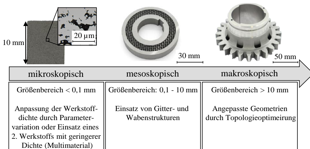
Abbildung 16: Größenordnung der Leichtbaustrukturen beim Laser-Strahlschmelzen (nach REINHART & TEUFELHART 2011)
