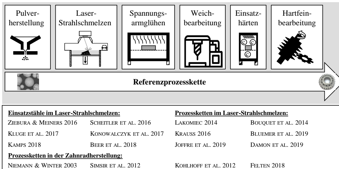
Abbildung 49: Referenzprozesskette für additive Bauteile aus Einsatzstahl
