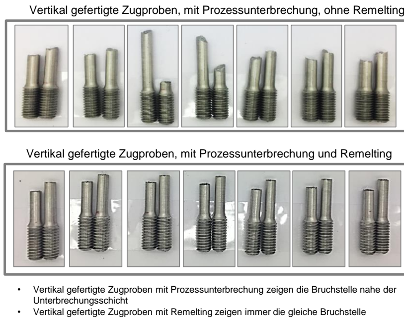
Abbildung 116: Gebrochene Zugproben aus AlSi10Mg mit Prozessunterbrechung.
