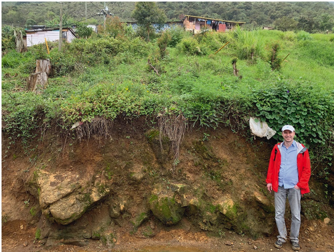
Fig. 6 Block-in-matrix structure of the deeply weathered dunite at the toe of a shallow landslide (Scale: person 1.8 m) Block-in-Matrix-Struktur des tiefgründig verwitterten Dunits an der Stirn einer flachgründigen Rutschung (Maßstab: Person 1,8 m)
