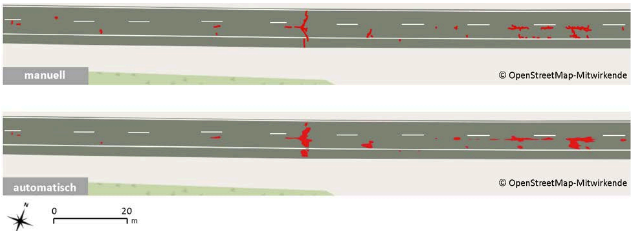
Abb. 2: Vergleich von manueller (oben) und automatischer Risskartierung (unten) für die circa 200 m lange Teststrecke.
