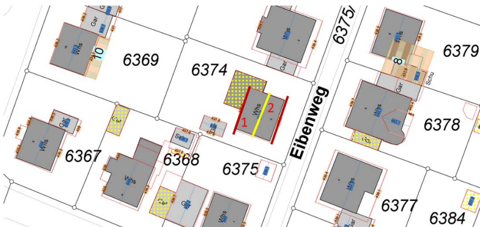
Abb. 2: Ermittlung First und Trauf durch Verschnidung von Laserscannerpunkten und Kanten unter Berücksichtigung von Topologieregeln.
