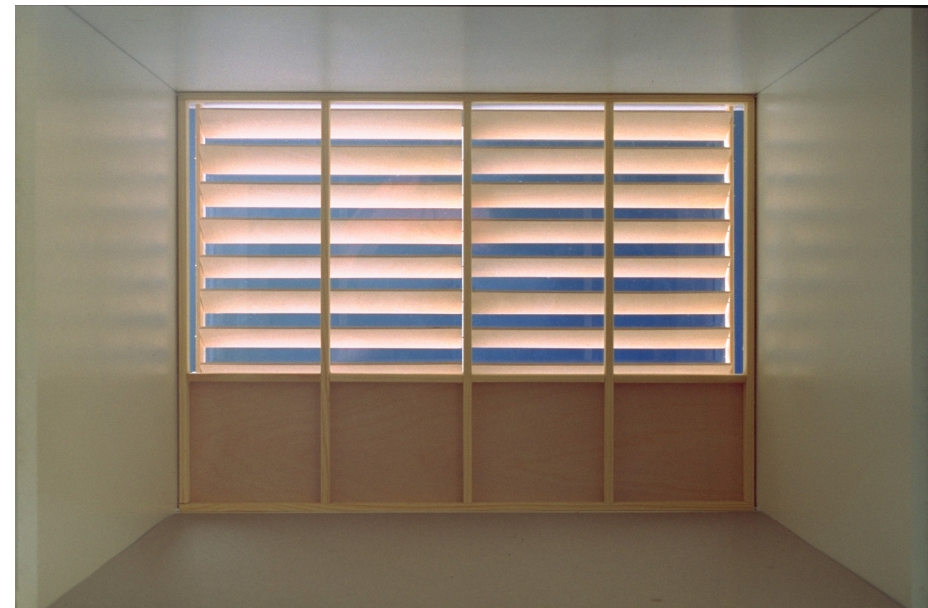
Fig. 12: Innenaufnahme des Modells der Meßeinrichtung mit Zweite-Haut-Fassade, Lamellen geneigt
