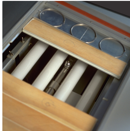
Fig. 13: UV-Bestrahlungslampen der Bewitterungskammer [21]
