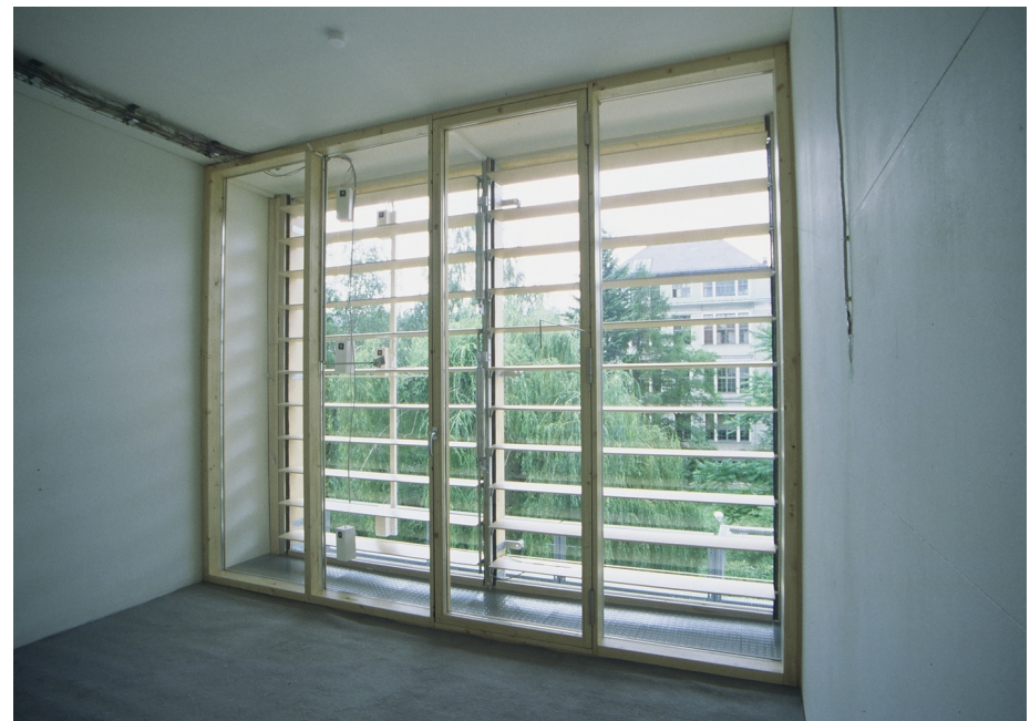
Fig. 4: Testfassade von innen, Holz-Lamellen mit Deckschicht aus Birkensperrrholz
