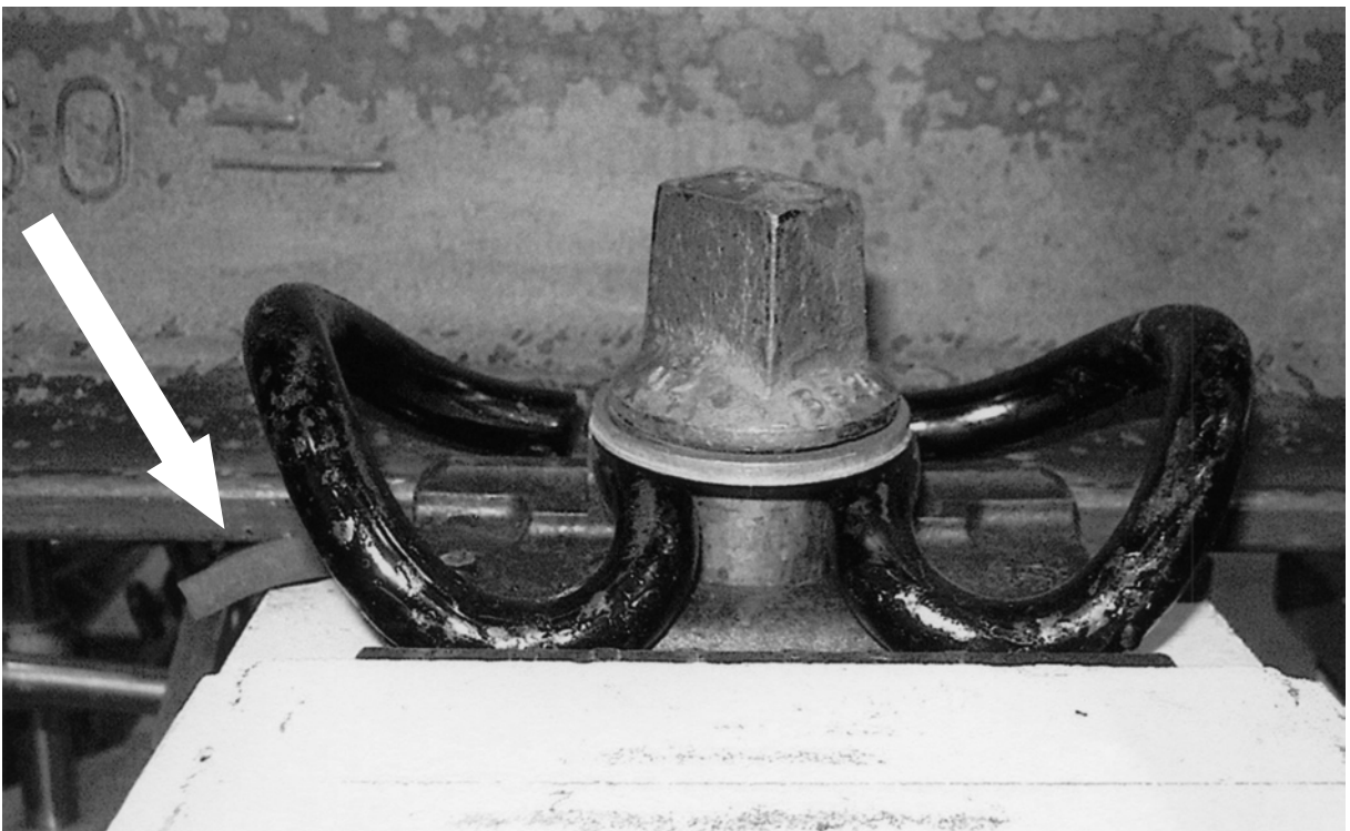
Abb.: Verformte Zwischenlage Zw 700a bei gleichzeitiger Einwirkung der Längskraft und einer Vertikalkraft von 75 kN
