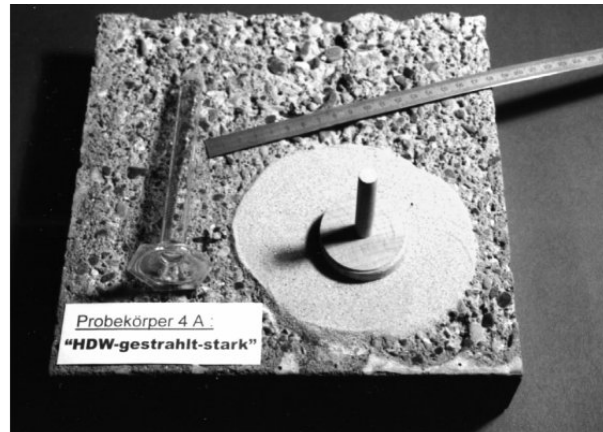
Abbildung 3.14: Hilfsmittel des Sandflächenverfahrens nach Kaufmann
