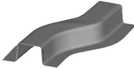
Abbildung 7: Modellierung eines umgeformten Bauteils aus dem Automobilbau mit B-Spline Oberfläche [Muthler 04].
