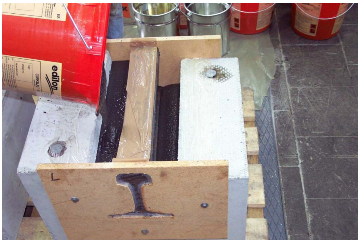
Abb. 3.6: Vergießen der Schiene
