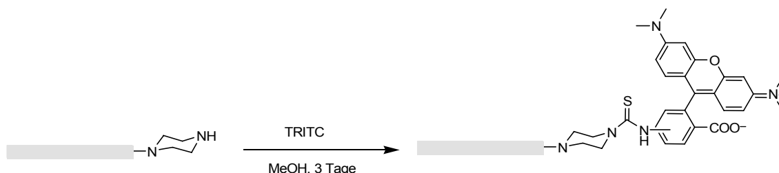
Abb. 4.22: Fluoreszenzmarkierung eines piperazinfunktionalisierten Polymers.
