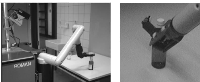
ABBILDUNG 1.1: Greifen einer Flasche durch den semiautONOMEN Serviceroboter ROMAN und Ausschnitt eines typischen Kamerabildes.
