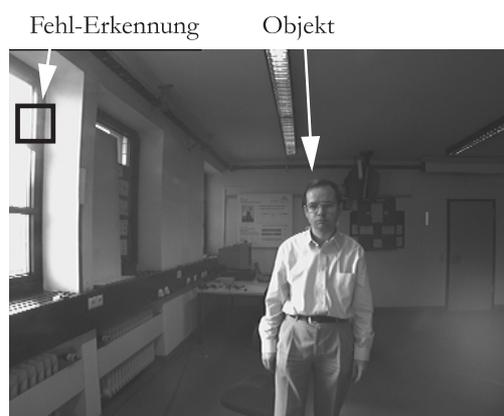
ABBILDUNG 6.18: Typische Fehl-Detektion am linken Bildrand bei partieller Überbelichtung des Fensterbereichs. Durch die automatische Blenden- und Verstärkungssteuerung wird das restliche Bild unterbelichtet.
