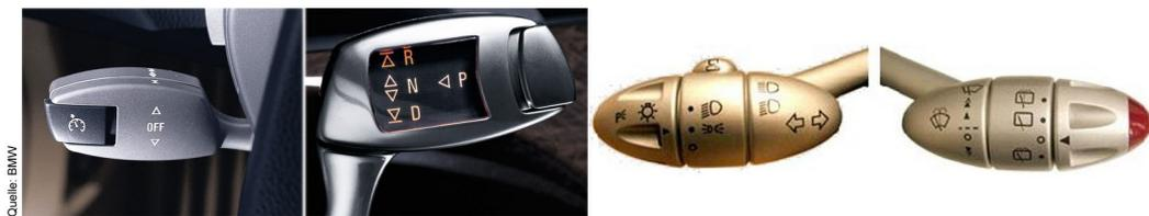
Bild 10 Komplexes Bedienelement Lenkstockhebel
