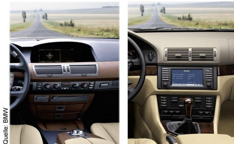
Bild 3 Integrale Anzeige und Bedienung mit (links), bzw. ohne (rechts) örtlicher Trennung der Anzeigefläche und des Bedienelements
