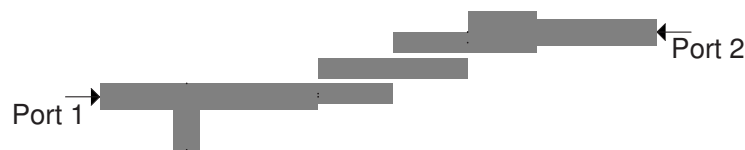
Abb. 4.5: Design des Filters in Mikrostreifentechnik.
