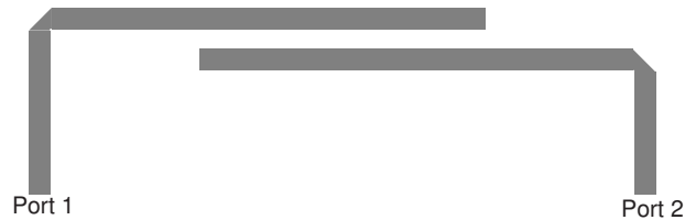
Abb. 4.15: Koppler für die Verkopplung zweier Patchantennen mit Simulationsports.
