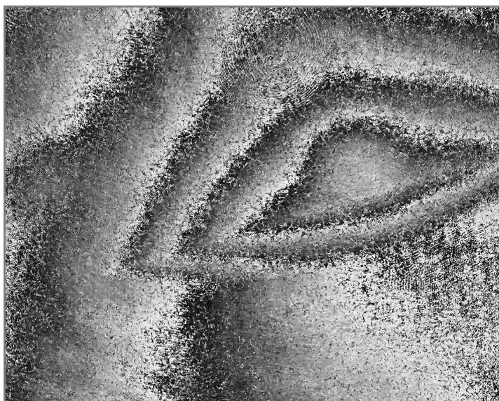
*Abbildung 5.3: Phasenbild der Delle in einem Alublock*
