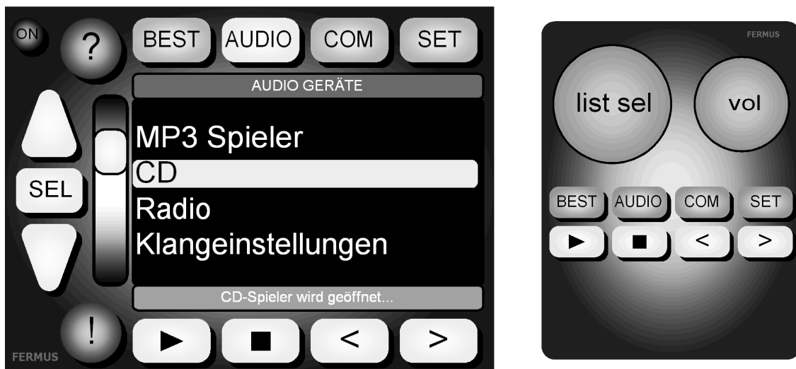
Abb. 7.10: Grafische Benutzeroberfläche zur Bedienung von Infotainmentdiensten im Fahrzeug (links) und zugehörige Bedieneinheit (rechts) als Konzeptbild
