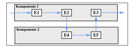
Abbildung 5.4: Kontextwechsel eines Ausführungsfadens.
