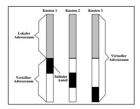
Abbildung 10.5: Die initiale Konfiguration des DSM.
