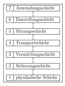
Abbildung 8.2: Schichtenmodell für Netzwerke nach ISO/OSI.
