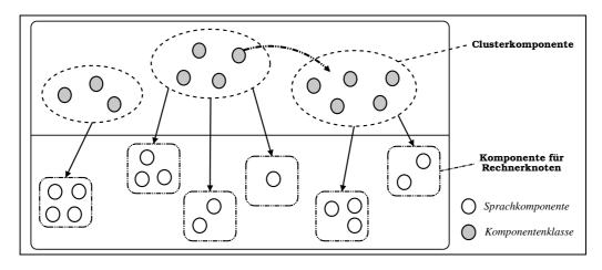
Abbildung 10.18: Zuordnung von Komponentenklassen zu Clustern in CDSL.
