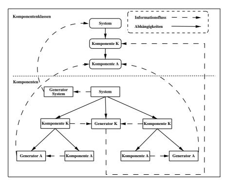
Abbildung 10.13: Informationsfluss zwischen Komponenten, Generatoren und Komponentenklassen.
