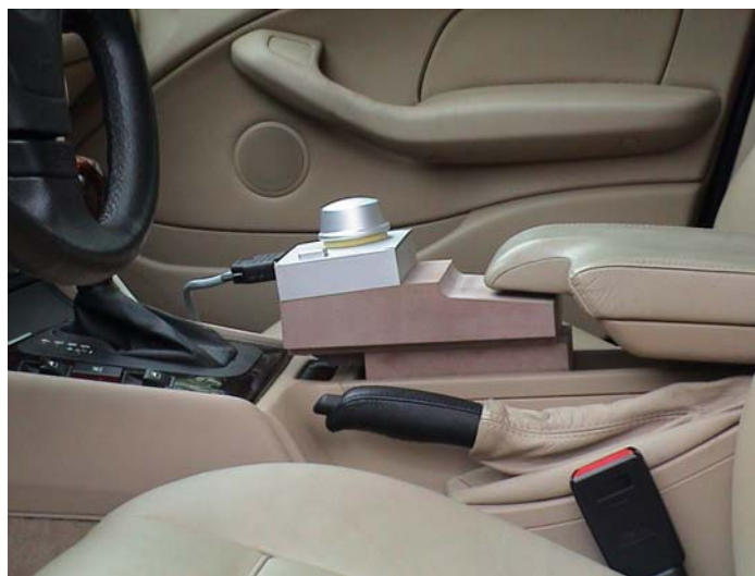
Abbildung 5-1: Zwischen Fahrer und Beifahrersitz montierte Bedieneinheit, die im Wesentlichen aus einem Dreh-Drücksteller und einer separaten Taste für die Rücksprungfunktion besteht. Das Gehäuse kann in Längsrichtung verschoben werden.
