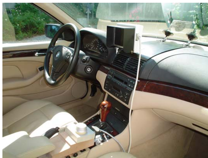
Abbildung 5-3: Fahrzeuginnenraum des Versuchsfahrzeugs mit Bedieneinheit und Display. Der Bildschirm verfügt über eine Sonnenblende und ist in der Mitte des Armaturenbretts auf Höhe des Tachometers montiert.
