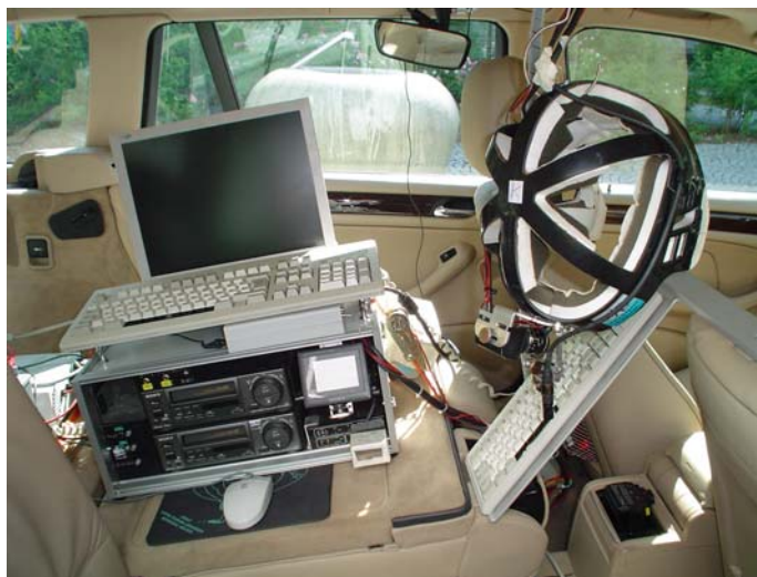
Abbildung 5-5: Einbau der Videoaufzeichnungsgeräte des JANUS-Systems und der Steuerungsgeräte für das LfE-Cruise auf der Rückbank des Versuchsfahrzeugs. Mit dem innen eingebauten Rückspiegel kann der Versuchsbegleiter den nachfolgenden Verkehr im Auge behalten. Der JANUS-Helm ist zum Transport aufgehängt.
