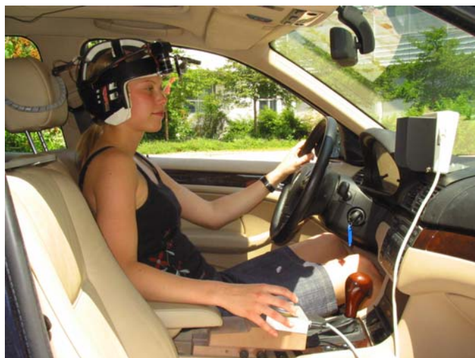
Abbildung 5-4: Versuchsperson mit JANUS-Helm im Versuchsfahrzeug. JANUS verfügt über zwei Kameras, mit denen die Blickrichtung des Probanden bestimmt werden kann.
