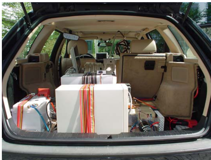
Abbildung 5-6: Einbau der Messcomputer im Kofferraum. Rechts und links sind die elektrischen Einbauten zu erkennen, die auch bei einem abgestellten Motor noch die Stromversorgung sichern.
