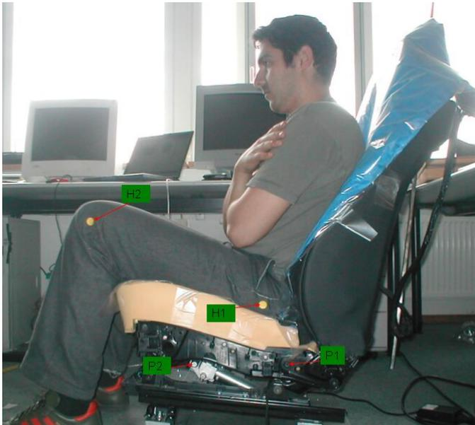
Abbildung 71: Markierungen an Versuchsperson und Sitz für die Validierungsversuche des Berechnungsmodells
