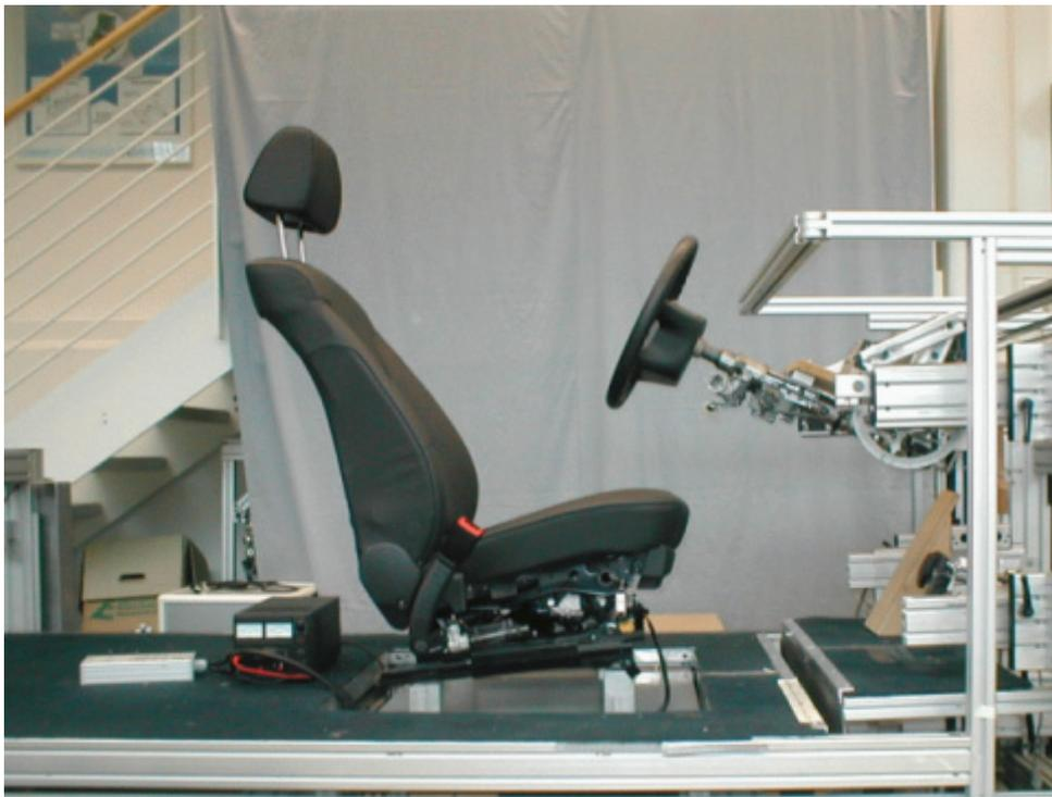
Abbildung 13: Realsitz-Mockup mit montiertem Sitz
