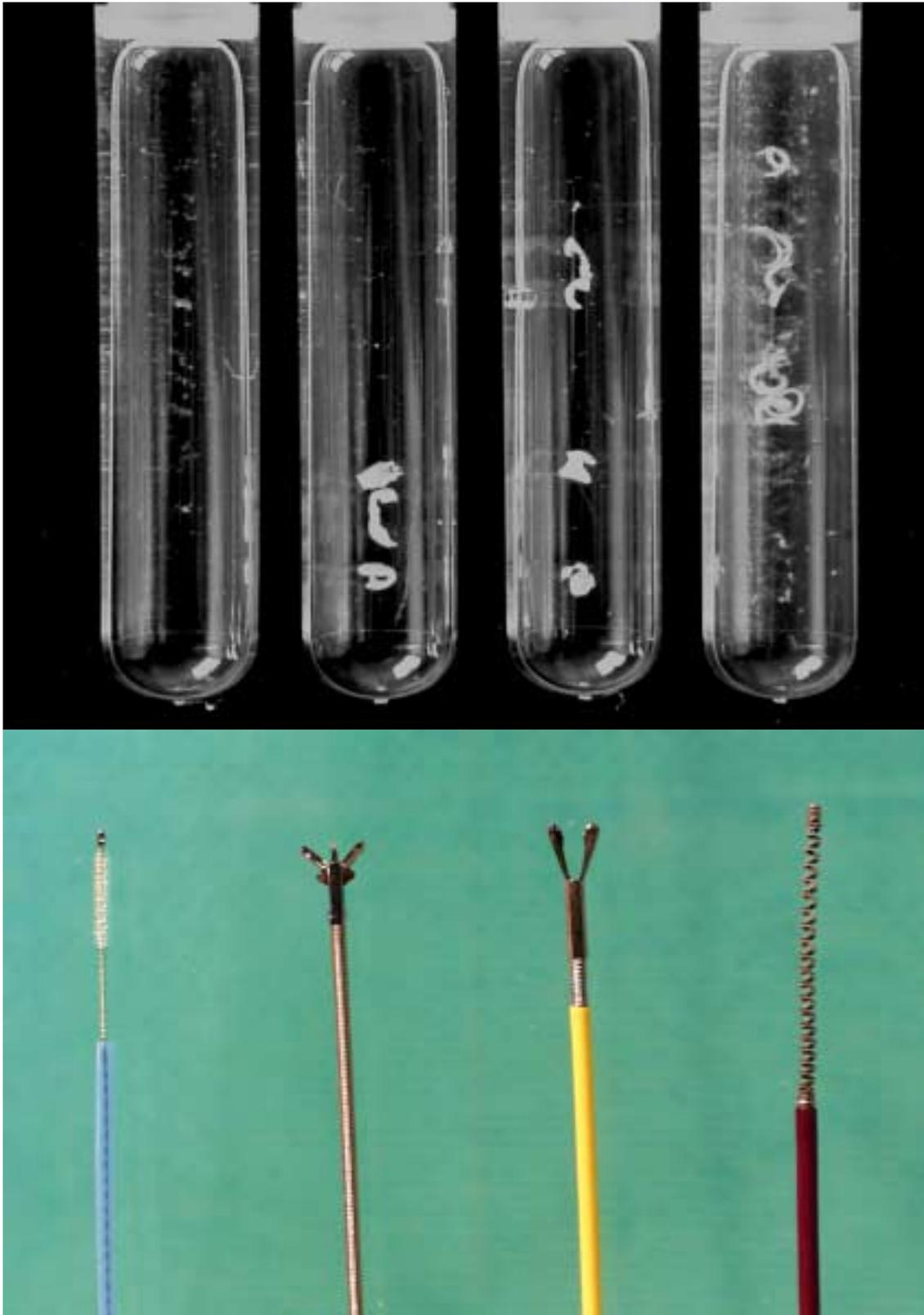
Abb. 29: Gewebeausbeute mit verschiedenen endoskopischen Instrumenten; die den einzelnen Instrumenten, Zytologiebürste, Dornzange, Multibitezange und Zytospirale (von links nach rechts), zugeordneten Gläschen zeigen die mit dem jeweiligen Instrument gewonnene Gewebeausbeute
