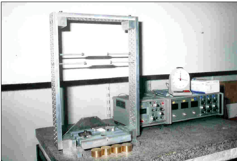
Abb. 2.3: Versuchsaufbau mit Spannrahmen, Gewichte und Verstärker
