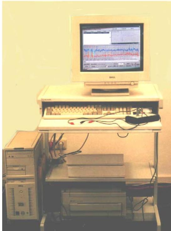
Abb.1: Das AECCG-Gerät, bestehend aus PC, Software und Schnittstelleneinheit mit Elektroden
