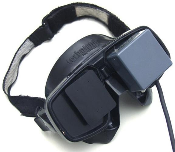
Abb. 10 Lichtausschließende Brille mit aufgesetzter Infrarotkamera zur Registrierung von Augenbewegungen (Originalfotographie)
