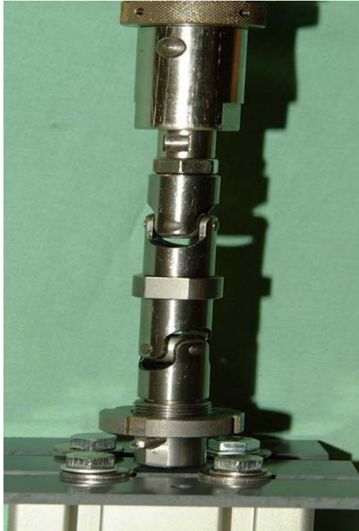
Abbildung 13: definitiver Versuchsaufbau mit Kardangeln und Detailaufnahme Schraubenhalterung
