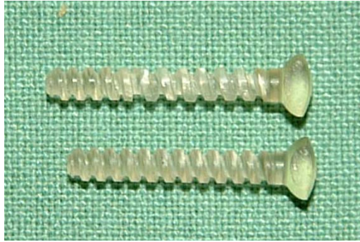
Abbildung 25: PLLA-PGA- Schraube vor (unten) und nach Ausreißversuch. Sichtbar ist die plastische Verformung (Verlängerung) der Schraube durch die Zugkraft
