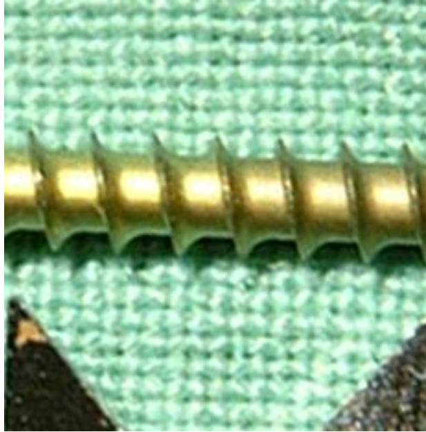
Abbildung 21: Messung tragender Querschnitt am Beispiel Titan 2,0 x 15 mm
