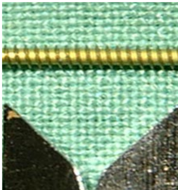
Abbildung 5: Messung der Gewindesteigung, Beispiel 1,2 x 13 mm
