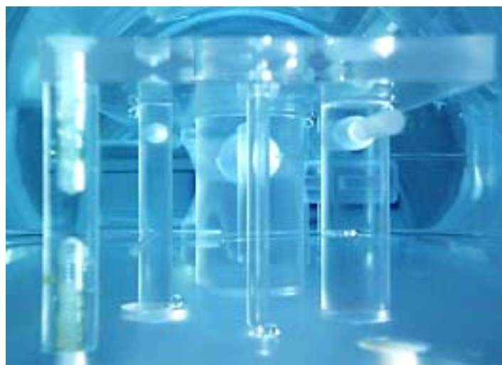
Abbildung 2: Die zur Vermessung eingebrachte Stabkonstruktion im Phantom
