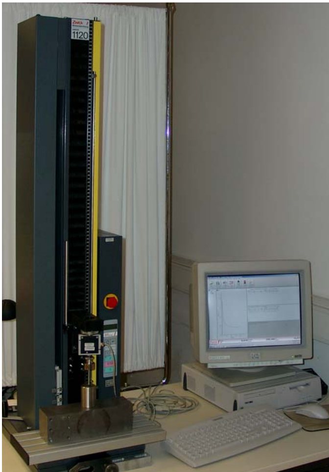
Abbildung 2.9 links: Übersicht der Apparatur; Abb. 2.10 rechts: Kraftmessdose (Prüfmittel KM-09), Stempel und ausgefräster Metallzylinder.
