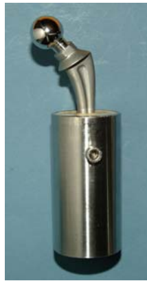
Abb. 2.1.4: Hüftstiel mit aufgestecktem Kugelkopf, eingebettet in die Implantataufnahme
