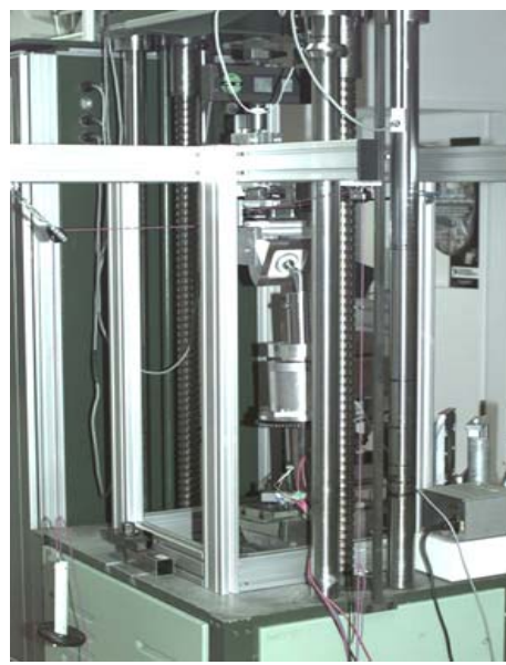
Abb. 2.1.6: Luxationsprüfstand in der seitlichen Übersicht, integriert in die Universalprüfmaschine; untersuchte Bewegungen: maximale Innen- und Außenrotation bei 10° Extension/15° Adduktion (links) und bei Neutralstellung (rechts)
