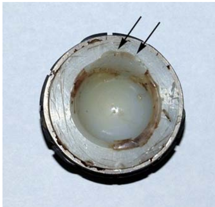
Abb. 4.1: Revisionspfanne mit Randdeformierungen und vermehrtem Abrieb des Polyethylen-Inserts aufgrund eines repetitierenden Impingements
