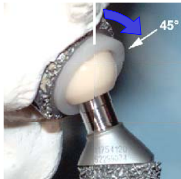
Abb. 3.1.1.1: Darstellung einer linksseitigen Hüftendoprothese von ventral mit Insert-Drehung im metallischen Gehäuse aus der 0°-Position (= 12 Uhr) um 45° nach dorsal (d.h. 13 30 Uhr)
