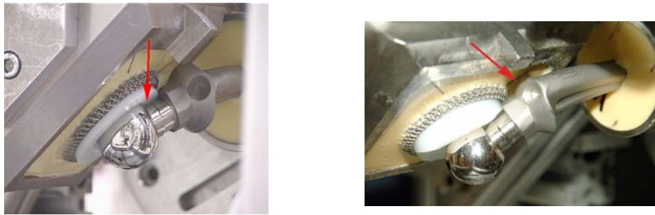
Abb 3.1: Prüfstand bei 90° Flexion und 0° Adduktion: Anschlagen des Prothesenhalses am Pfannenrand (= primäres Impingement, siehe Pfeil) (links) und Abstützung des Halses am äußeren Pfannenrand (= sekundäres Impingement) sowie des Stielkragens am Einbettungsmaterial (= tertiäres Impingement, siehe Pfeil) (rechts)
