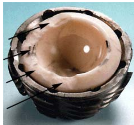
Abb. 4.2: Revisionspfanne mit halb-zirkulären Randabplatzungen (siehe Pfeile) des keramischen Inserts
