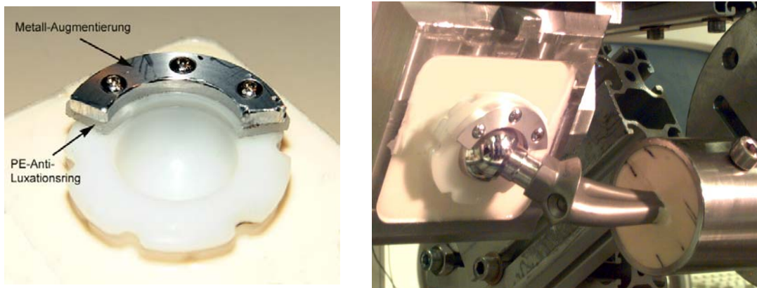
Abb. 2.2.1.10: C-Hüftpfanne (Voll-PE-Pfanne) mit PE-Antiluxationsring und Metall-Augmentierung (links); Voll-PE-Pfanne mit Augmentierung in 0°-Position während der Artikulation im Prüfstand bei 90° Flexion und 0° Adduktion des Gelenkes (rechts)
