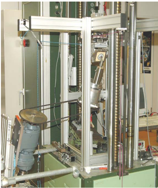
Abb. 2.1.6: Luxationsprüfstand in der seitlichen Übersicht, integriert in die Universalprüfmaschine; untersuchte Bewegungen: maximale Innen- und Außenrotation bei 10° Extension/15° Adduktion (links) und bei Neutralstellung (rechts)
