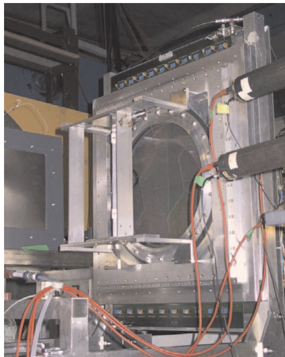
Abbildung 3.3.: Blick aus Strahlrichtung unter 45^\circ auf den geöffneten HIRICH (die Abdeckung des Radiatorraums fehlt). Der Spiegel liegt genau entlang der Blickrichtung, ein Teil des Radiatorgehäuses ist als schwarzer Halbkreis vor der \text{CaF}_2 -Scheibe (hexagonale Struktur) zu erkennen. Dahinter liegt die Pad-Kathode mit der Beschichtung aus Graphit und CsI.
