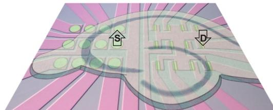
**Abbildung 1.1:** Neuroelektronisches Interface. Über den Eigenbauchip ist sowohl eine Stimulation (S) als auch eine Detektion (D) neuronaler Aktivität in einem Hirnschnitt möglich.
