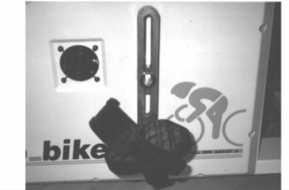
Abbildung 28: Radiusreduzierte Tretarmverkürzung montiert auf einem konventionellen Ergometer
