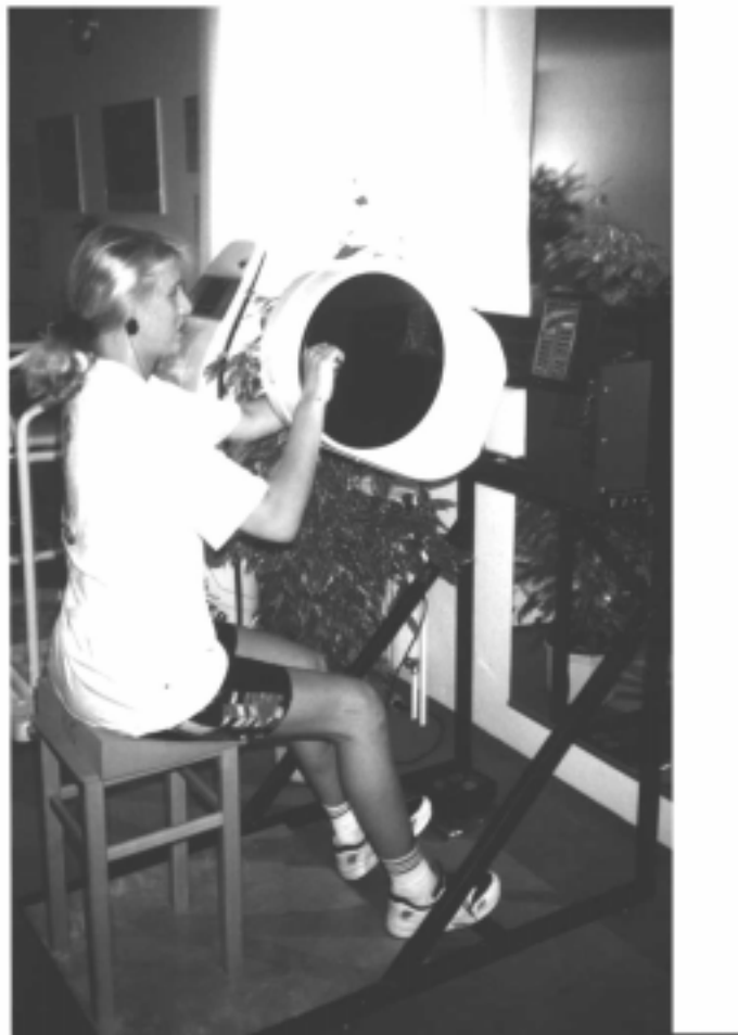
Abbildung 26: Die 2-Punkt-Belastung an einem konventionellen Armergometer
