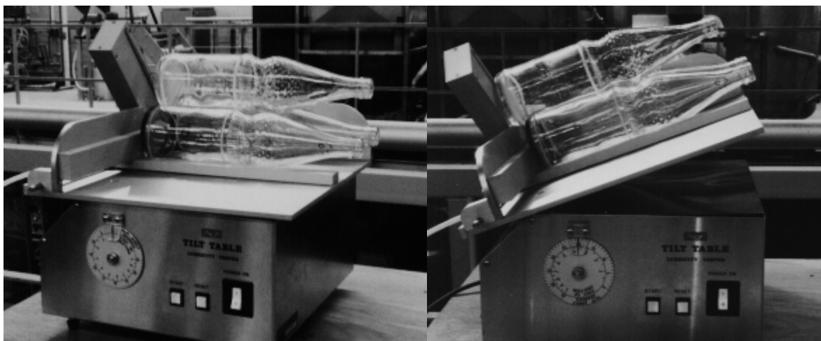
Bild 3.4. Tilt Table zum Bestimmen des Haftreibungskoeffizienten (hier zwischen 0,7-l-GDB-Flaschen)
