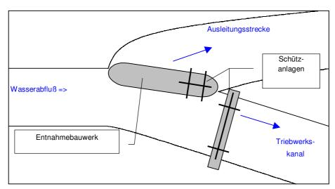
Abb. 5: Skizzierung eines Entnahmebauwerkes
