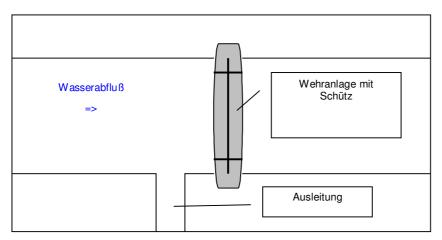
Abb. 8: Skizzierung einer Stauanlage
