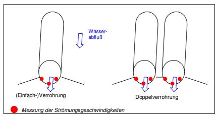
Abb. 12: Skizzierung einer Einfach- und einer Doppelverrohrung
