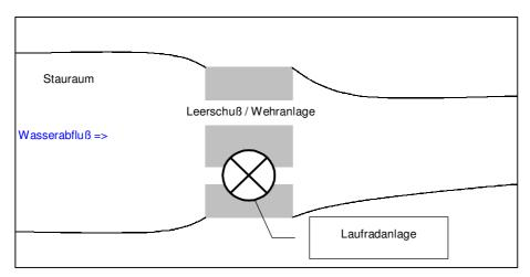
Abb. 13: Skizzierung einer Wasserkraftanlage
