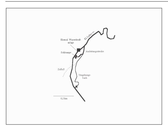
Abb. 19: Lageskizze der Wanderhilfe Winklmühle (Umgehungsbach), R: Punkt der Reusenkontrolle
