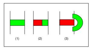
Abb. 1: Öffnung der Wanderwege an Querbauwerken (grüner Bereich): (1) kompletter Rückbau oder über die gesamte Breite durchwanderbares Querbauwerk, z.B. Sohlrampe; (2) über einen Teil der Breite durchwanderbares Querbauwerk, z.B. Teilrampe; (3) über eine Ausleitung umgehbares Querbauwerk, z.B. Umgehungsbach, technische Wanderhilfe
