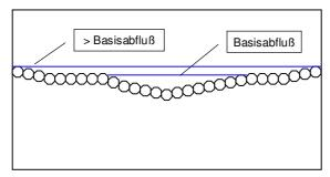
Abb. 52: Rauhe Rampe mit NQ-Gerinne (Querschnitt)
