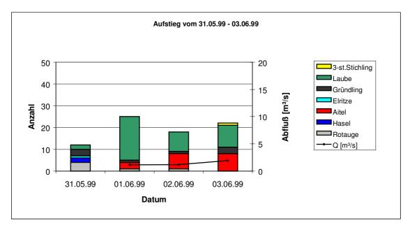
Abb. 77: Aufstieg der Fische in der Wanderhilfe Winklmühle im Zeitraum 31.05.99 – 03.06.99, Abfluß [m³/s]
