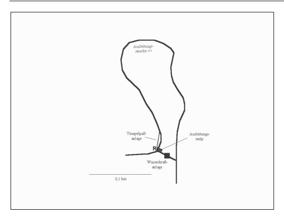
Abb. 25: Lageskizze der Wanderhilfe Hals, R: Punkt der Reusenkontrolle
