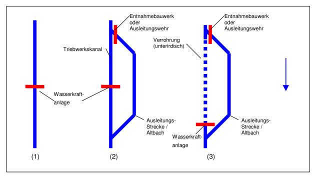
Abb. 45: Verschiedene Bauweisen von Wasserkraftanlagen: (1) Lauf- oder Flußkraftwerk, (2) Ausleitungskraftwerk mit oberirdischem Triebwerkskanal, (3) Ausleitungskraftwerk mit unterirdischer Verrohrung oder Stollen statt Triebwerkskanal, Pfeil: Fließrichtung.
