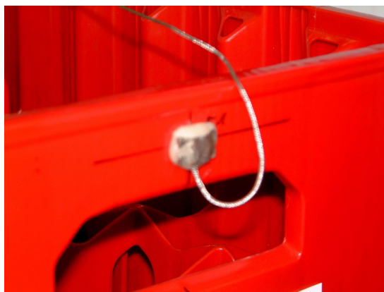
Abbildung 3-9: Anbringung eines Beschleunigungsaufnehmers am Kastengriff
