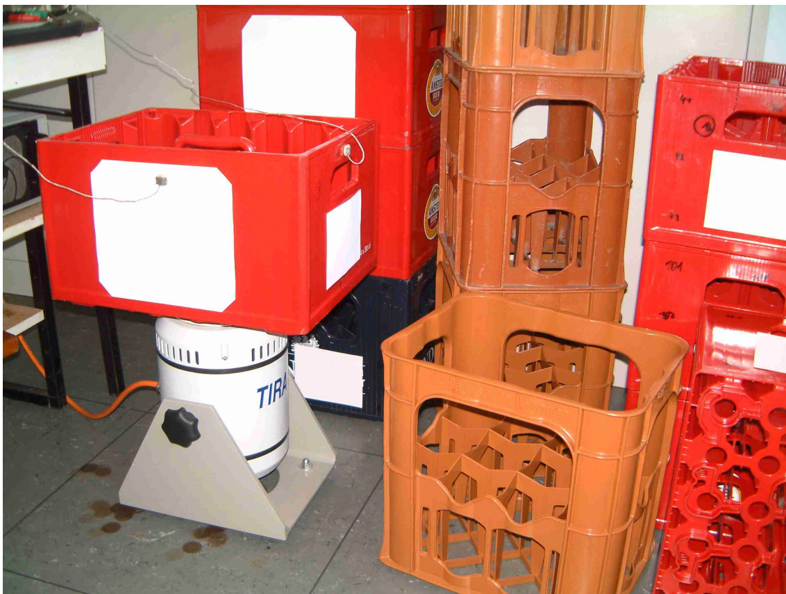
Abbildung 3-8: Shaker mit Prüfling und positionierten Sensoren
