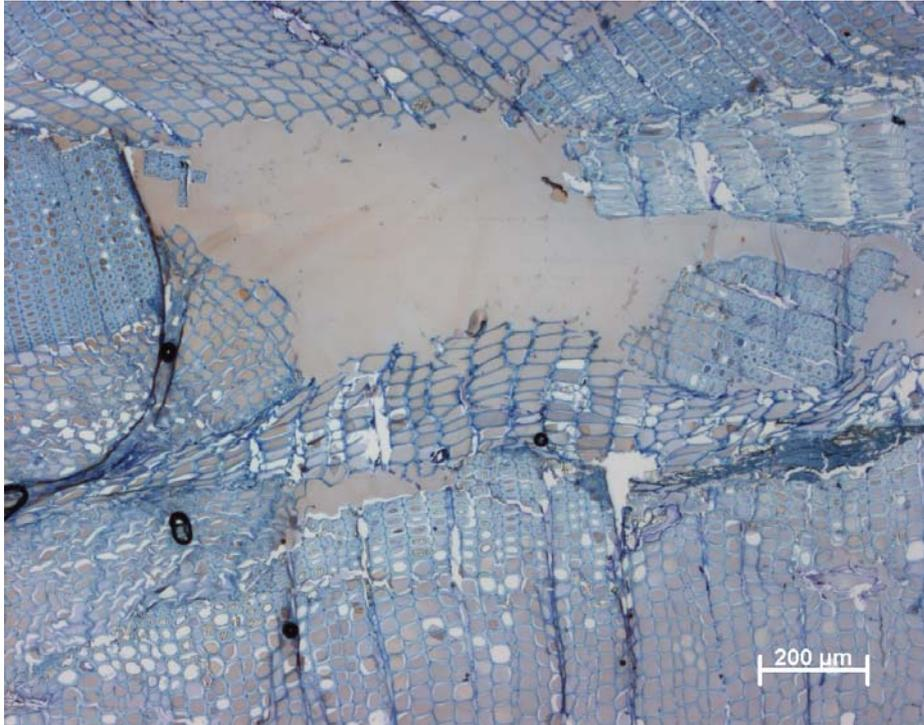
**Abbildung 18:** *Typische interpartikuläre Pore einer OSB-Platte im Querschnitt*
