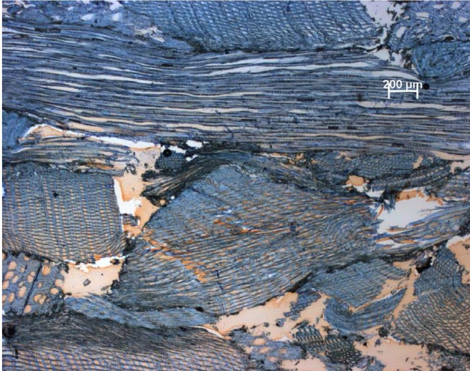
**Abbildung 17:** *Querschnitt des Mittelschichtbereiches einer Spanplatte*
