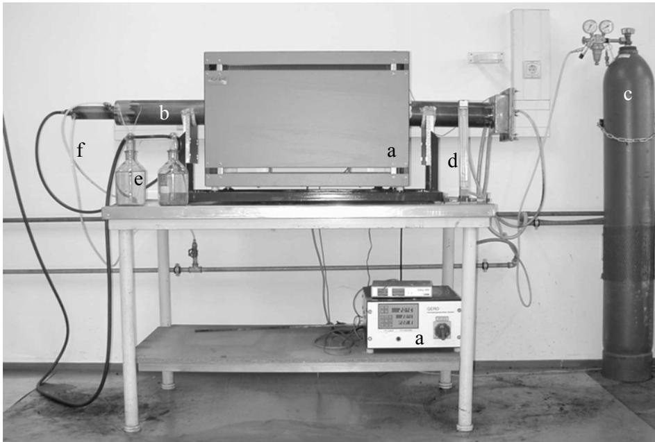
**Abbildung 14:** *Pyrolyseofen GERO mit speziell angefertigter Retorte*
