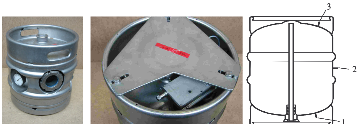
Bild 3.7: Schaueg (links), DataKeg (Mitte) und eine Skizze des 30-l-DIN-Edelstahl-Messkegs (rechts). 1-3 Positionen der Gewindebolzen.
