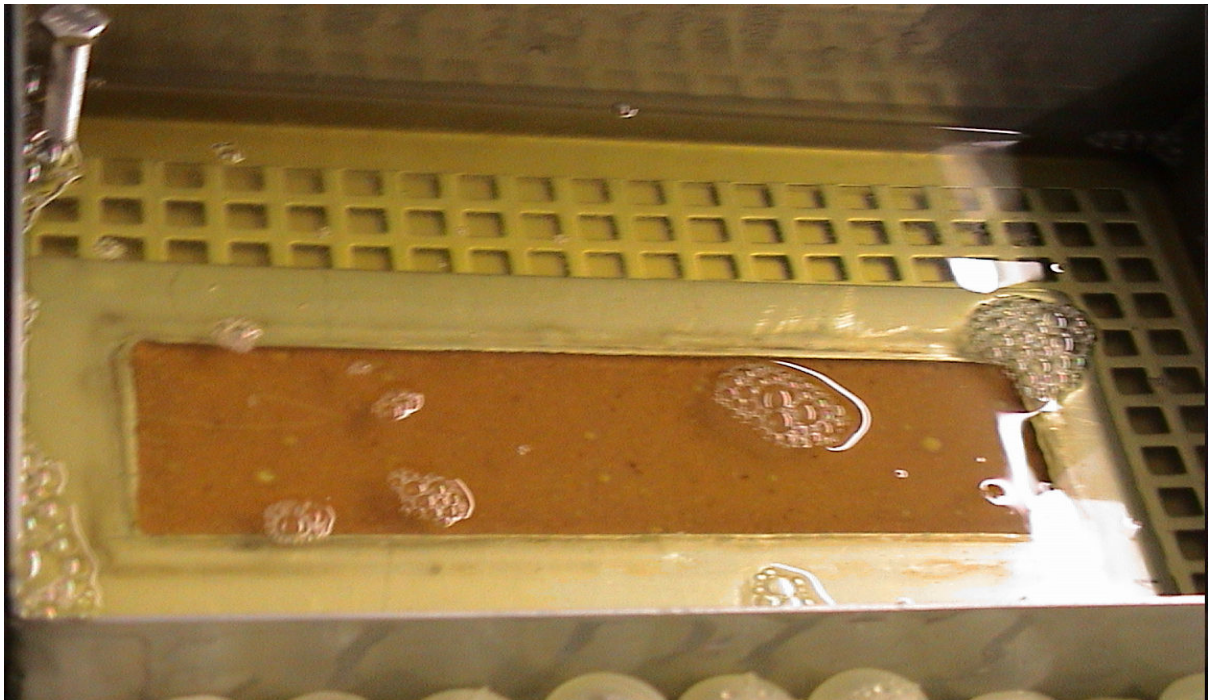
Bild 3.10: In das Temperierbad mit Lauge eingebrachte Trägerplatte mit Hefe.
