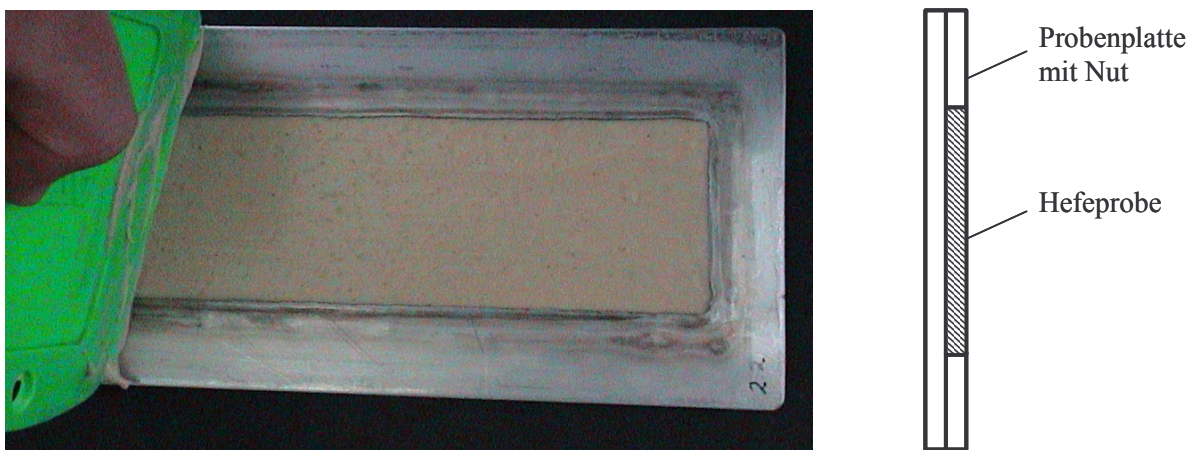
Bild 3.9: Trägerplatte mit in der Nut eingebrachter Hefe als Testverschmutzung.
