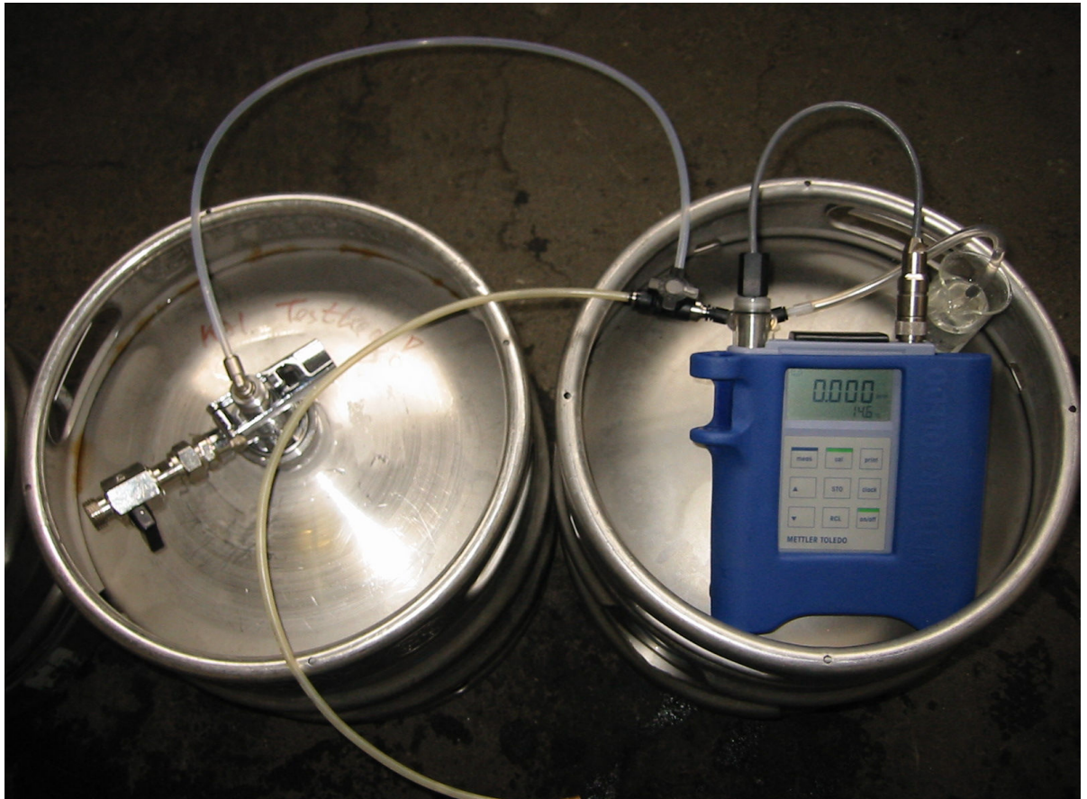
Bild 3.8: InTap Sauerstoffmessgerät, im Versuchsaufbau zum Bestimmen des Sauerstoffgehalts der Gasatmosphäre eines Kegs.
