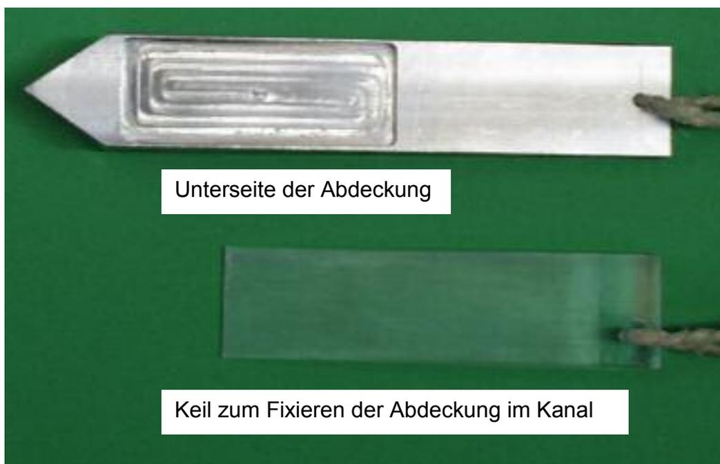
Bild 3.13 Abdeckung der Meßstrecke mit Keil zum Einklemmen
