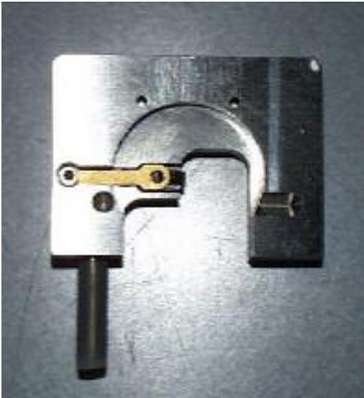
Bild 3.3 Tipholder für Messungen im Trockenen
