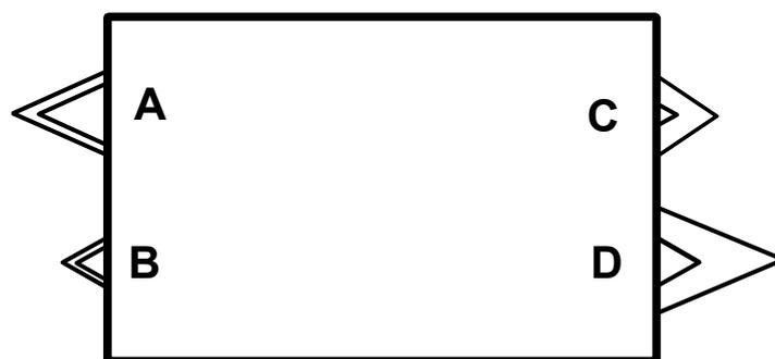
Bild 3.5 Anordnung der Cantilever am Substrat: (A) lang-dünn, (B) kurz-dünn, (C) kurz-dick, (D) lang-dick
