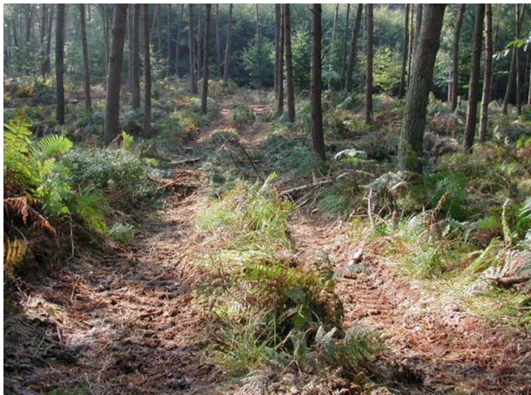
Abb. 49: Im Bereich des Hanges lag der Bodenwassergehalt zum Befahrungszeitpunkt mit 33 % über dem errechneten Grenzwert von 30 %. Die Spurtiefe lag im Mittel zwischen 10 und 13 cm. Die Bodenveränderungen lagen an der Grenze zum nicht Akzeptablen. (Foto: Matthies)
