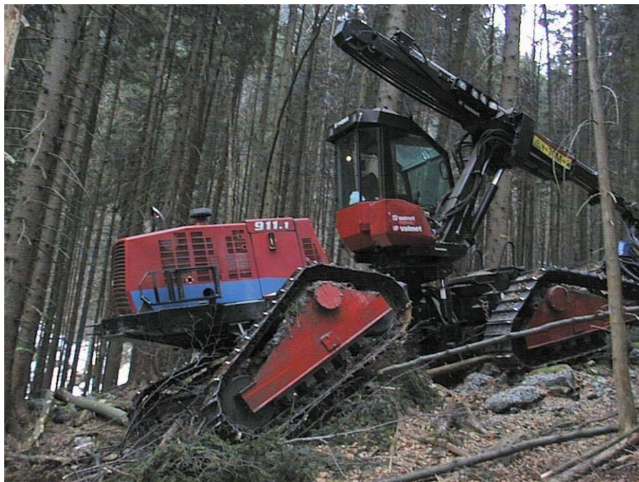
Abb. 2: Beispiel für einen auch im Steilgelände einsetzbaren Harvester (Foto: von Bodelschwingh)
