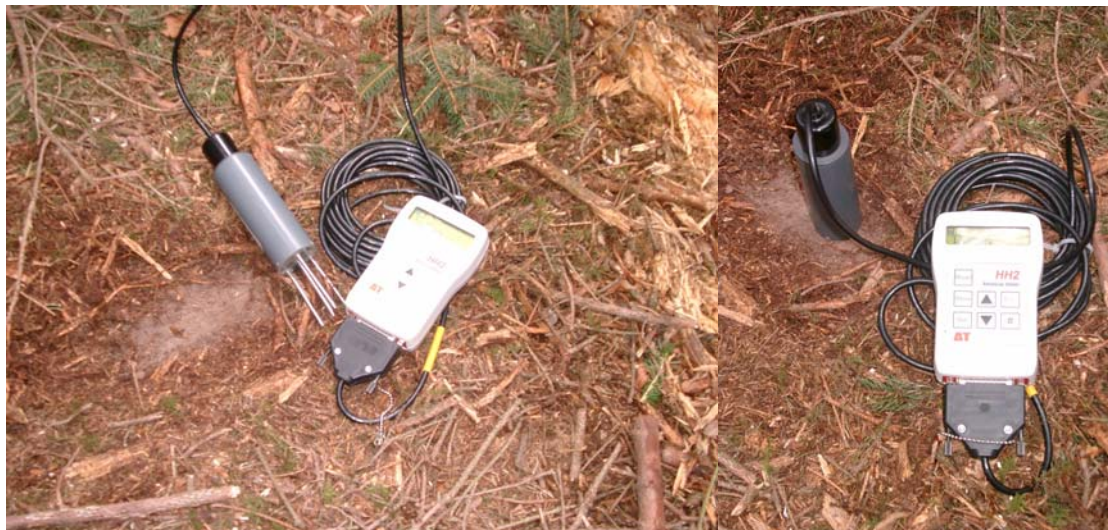
Abb. 52: FDR-Sonde, links mit frei erkennbaren Sondenspitzen, rechts während einer Messung
