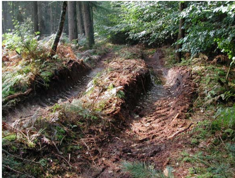
Abb. 50: Am Hangfuß lag der Bodenwassergehalt zum Befahrungszeitpunkt bei 40 %. Die Spurausprägung und die Bodenveränderungen waren inakzeptabel. (Foto: Matthies)
