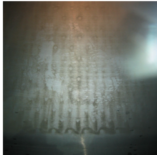
Abbildung 26: Fouling nach 3 Suden
