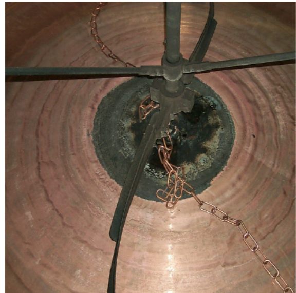
Abbildung 3: Direkt beheizte Pfanne [32] Abbildung 4: Ketten in direkt beheizter Pfanne [93]
