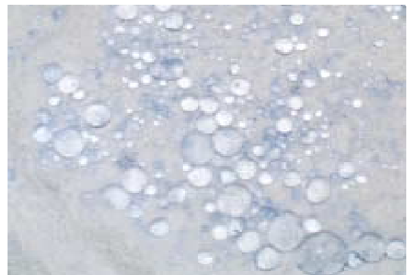
Abb. 4.52: Hydrophobierte Kieselsäure, zu welcher 30 % angefärbtes Wasser als Kontinuum zugegeben wurde; nach 3 weiteren Minuten Mischzeit
