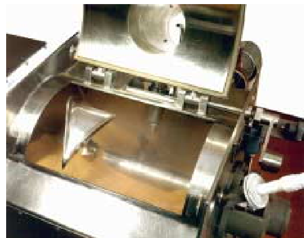
Abb. 2.16: Mit einer Einstoffdüse und einem Messerkopf ausgestatteter Pflugscharmischer
