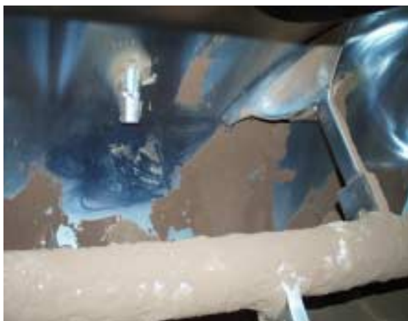
Abb. 2.15: Mit Zweistoffdüsen ausgerüsteter Pflugscharmischer (aromatisierte Tabakpulver; Fa. Alois Pöschl Tabakfabriken / Geisenhausen )
